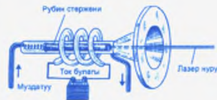
153-сүрөт. Рубин лазеринин жалпы көрүнүшү.
