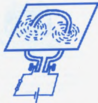
21-сүрөт. Тегерек токтун магнит талаасын үйрөнүүчү түзүлүш.
