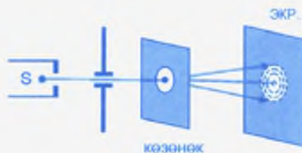
137-сүрөт. Көзөнөкчөдөн дифракциялык сүрөттөлүштүн пайда болушу.
