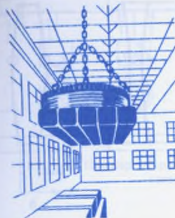
27-сүрөт. Оор жүк көтөрүүчү электр-магниттик кран.
