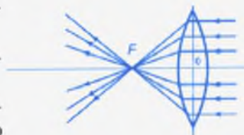
107-сүрөт. Томпок линзанын фокусу.
