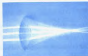
102-сүрөт. Томпок жана иймек линзадагы нурлардын жүрүшү.
