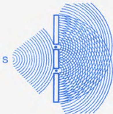
56-сүрөт. Ваннага куюлган суу бетинде пайда болгон толкундар аркылуу Гюйгенс принцибинин ырасталышы.
