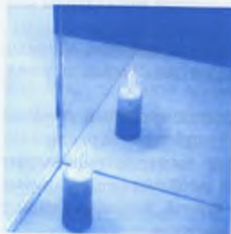
79-сүрөт. Шамдын жалпак күзгүдөгү сүрөттөлүшү.
