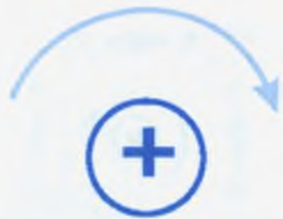
18-сүрөт. Бизден ары карай кеткен түз токтун магнит талаасынын багыты.
