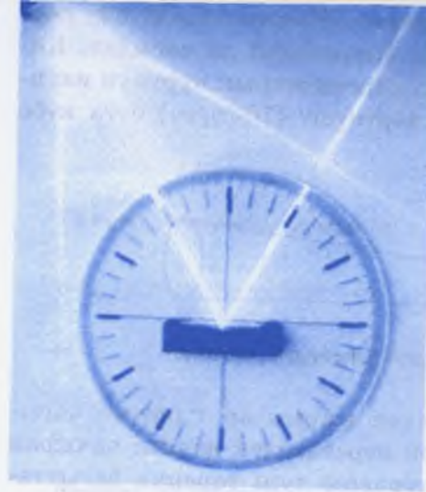
73-сүрөт. Жарыктын чагылуусун үйрөнүүгө арналган түзүлүш.
