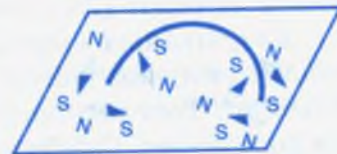
22-сүрөт. Тегерек токтун магниттик күч сызыктарынын багыты.
