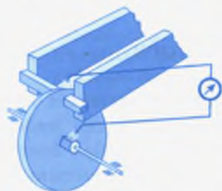
39-сүрөт. Фарадейдин электр генератору.
