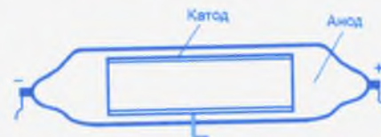
160-сүрөт. Гейгер–Мюллер эсептегичинин схемалык көрүнүшү.
