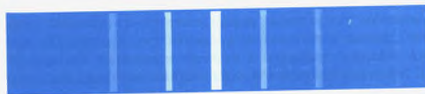
144-сүрөт. Монохроматтык толкундун (кызыл жарык) дифракциялык торчодон өтүшүндө алынган спектрлер.
