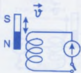
35-сүрөт. Чынжыр туюк болбосо индукциялык ток пайда болбойт.
